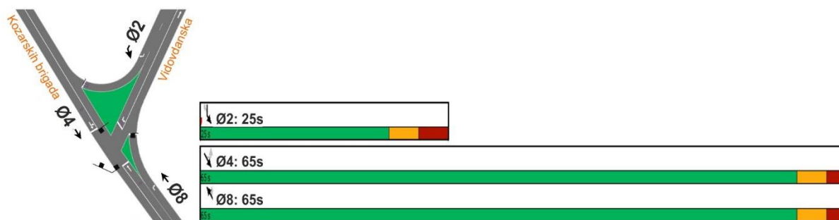
Slika 3-3 Predlog optimalnog signalnog plana na raskrsnici Kozarskih brigada – Vidovdanska
