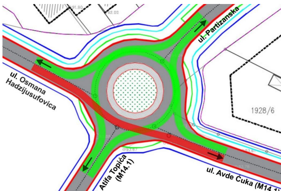
Slika 3-1 Predlog kružne raskrsnice R6 sa pretpostavljenim putanjama vozila u planskoj dokumentaciji
