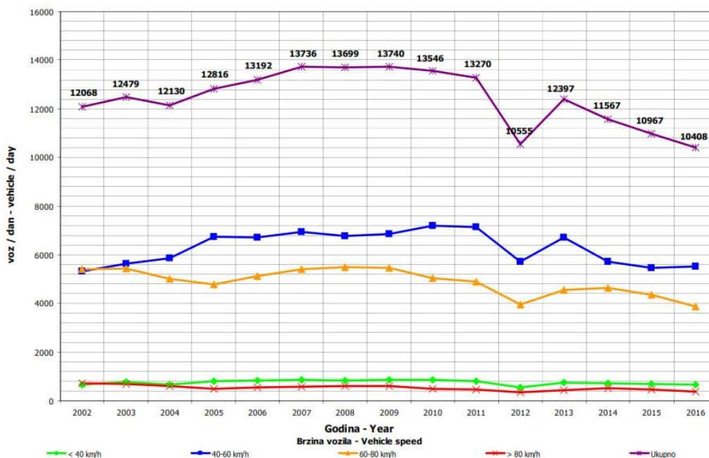
Slika 2-15 Primer neravnomernosti protoka na deonici puta M16 na kome je ostvareno najveće smanjenje zahteva za protokom u prethodnom periodu od 15 godina
