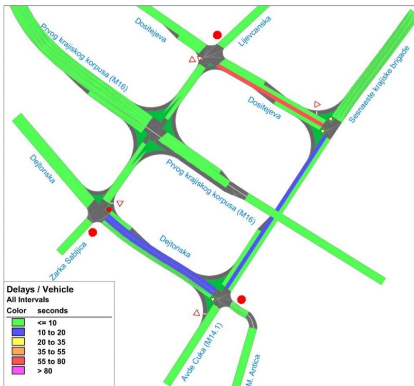
Slika 2-11 Vremenski gubici na prilazima raskrsnicama na petlji – postojeće stanje
