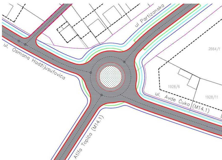
Slika 3-2 Predlog izmene predloga kružne raskrsnice R6 koji je dat u planskoj dokumentaciji radi onemogućavanja prolaska kroz zonu kruženja bez smanjenja prilazne brzine
